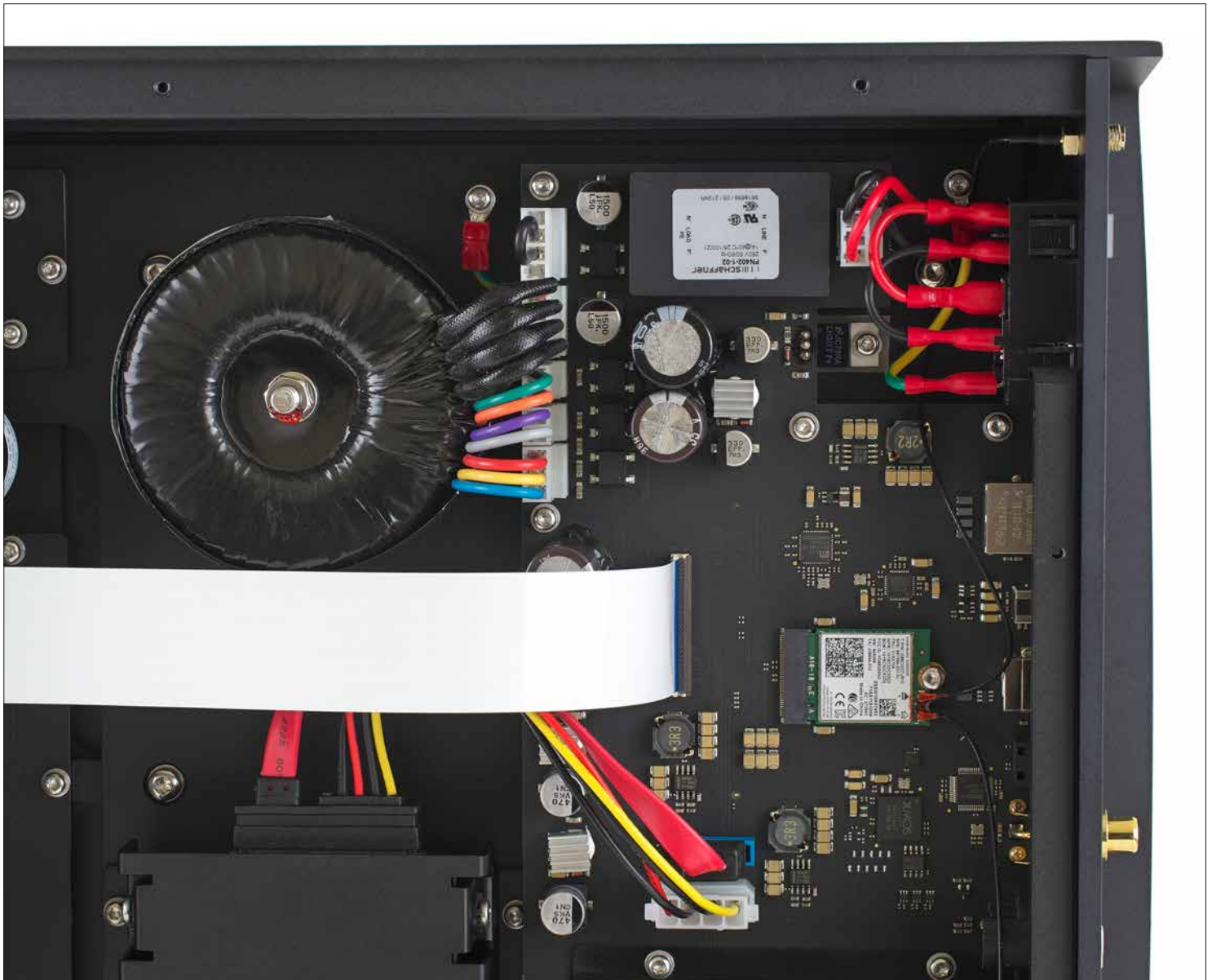
Im Inneren fällt der vergleichsweise kleine, besonders eigenrauscharme Trafo des aufwendigen Pure-Power-Linearnetzteils auf, das Gleichstromrauschen erheblich reduziert sowie eine sehr sorgfältige und kurzstreckige Verkabelung aufweist.
