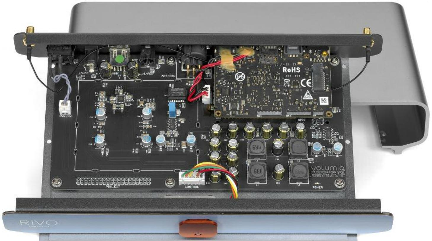
Die Software von Volumio wurde für Minimal-Computer wie den Raspberry Pi entwickelt. Auch im Rivo steckt letztlich ein Rechner, ein deutlich aufwendigerer. Bei ihm ist alles auf einen sauberen Signalweg angelegt, darum wird die Spannung an vielen Punkten stabilisiert und gefiltert
