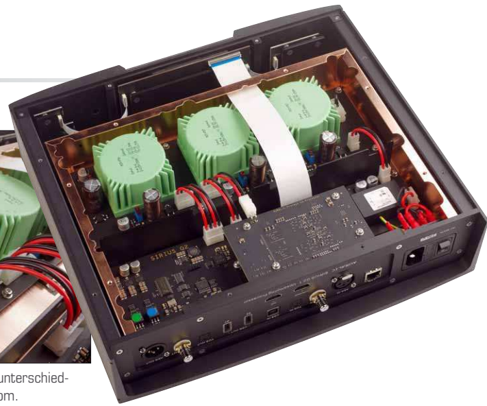
Stromversorgung und Audioelektronik sind nochmals baulich von einander getrennt
