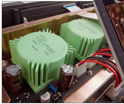
Mehrere Netzteile versorgen die unterschiedlichen Sektionen getrennt mit Strom.
