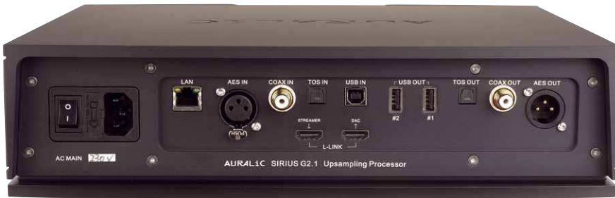
Der Sirius bietet alle gängigen Digitalanschlüsse und kann so mit praktisch jedem DAC kombiniert werden
