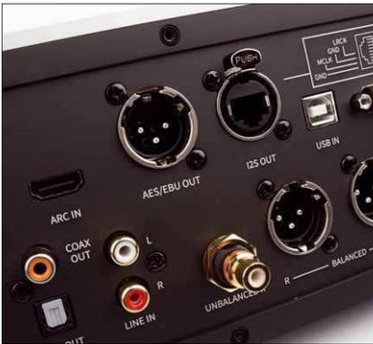
Dank ARC lässt sich der Fernsehton unkompliziert über die Anlage ausgeben
