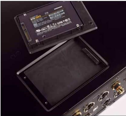
Mit wenigen Handgriffen lässt sich auf der Unterseite eine SSD einsetzen, um den RS150 zum Server zu machen
