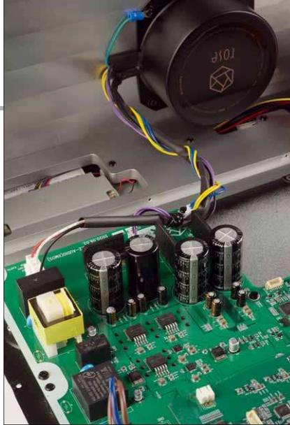
Um Platz zu sparen ist der große Trafo am soliden Deckel des RS150 angebracht
