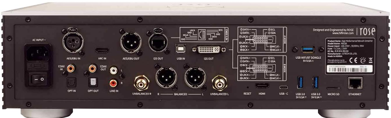
Zusätzlich zu den Streaming-Fähigkeiten des RS150 bietet das Gerät zahlreiche Anschlüsse für externe Quellen, DACs oder Verstärker
