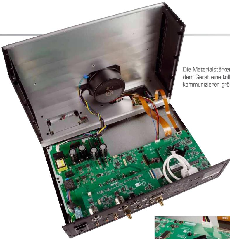
Die Materialstärken des Aluminiumgehäuses sind enorm und verleihen dem Gerät eine tolle Wertigkeit. Die verschiedenen Gerätesektionen kommunizieren größtenteils über feste Steckverbindungen
