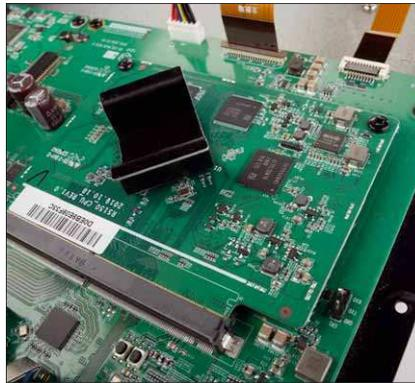
Der leistungsstarke Prozessor des Systems wird passiv, also geräuschlos, gekühlt
